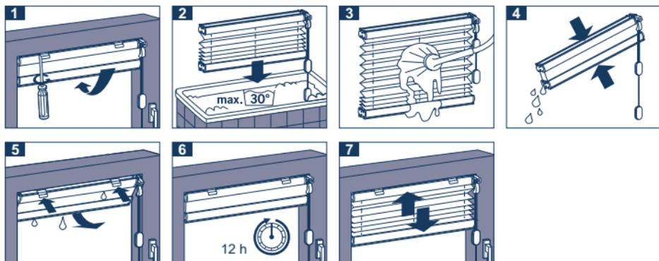
**1** Die Anlage aus der Halterung entfernen. **2** In ca. 30°C warmer Feinwaschmittellauge die Anlage schwenken. **3** Den Plisseestoff gut ausspülen. **4** Das Stoffpaket zusammenschieben und gut ausdrücken. Die Anlage darf nicht mehr tropfen. **5** Die Plisseeanlage feucht aufhängen. **6** Im geschlossenen Zustand trocknen lassen. **7** Während des Trocknens den Falstore mehrmals öffnen und wieder schließen, damit die Falten nicht verkleben.
