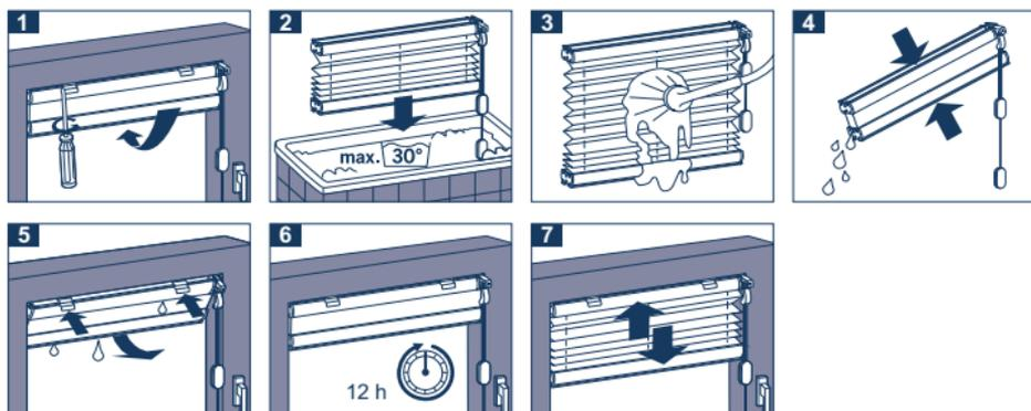
**1** Éliminer le plissee du crochet. **2** Agiter le plissee dans une lessive pour linge délicat à l'eau 30°C. **3** Bien éliminer les restes de lessive. **4** Plier le paquet de tissu et compresser jusqu'à ce que le store n'est pas trempé. **5** Suspending à l'état humide. **6** Laisser sécher plis repliés. **7** Alors que le séchage ouvrir et fermer le store plusieurs fois afin que ne colle pas les plis.
